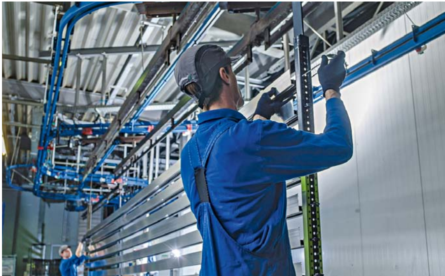
Die Werkstücke werden manuell auf den Warenträger montiert, bevor sie in die Vorbehandlung fahren.
