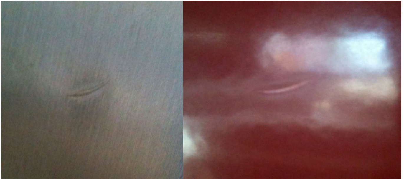
Bilder: Kratzer im Untergrund vor & nach Beschichtung
