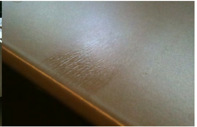
Abdrücke von Zwischenlagen wegen Hitzeeinwirkung
